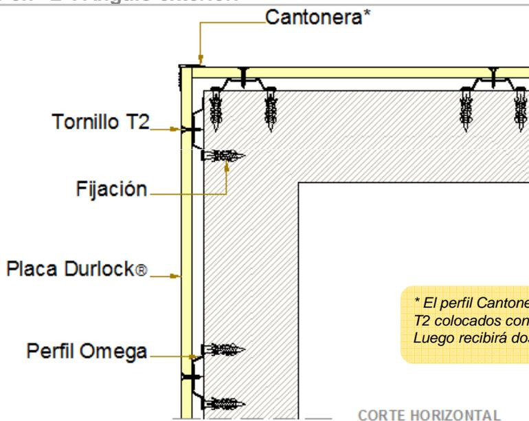
\* El perfil Cantonera podrá fijarse con tornillos T2 colocados con una separación de 15cm. Luego recibirá dos manos de masilla Durlock®.
